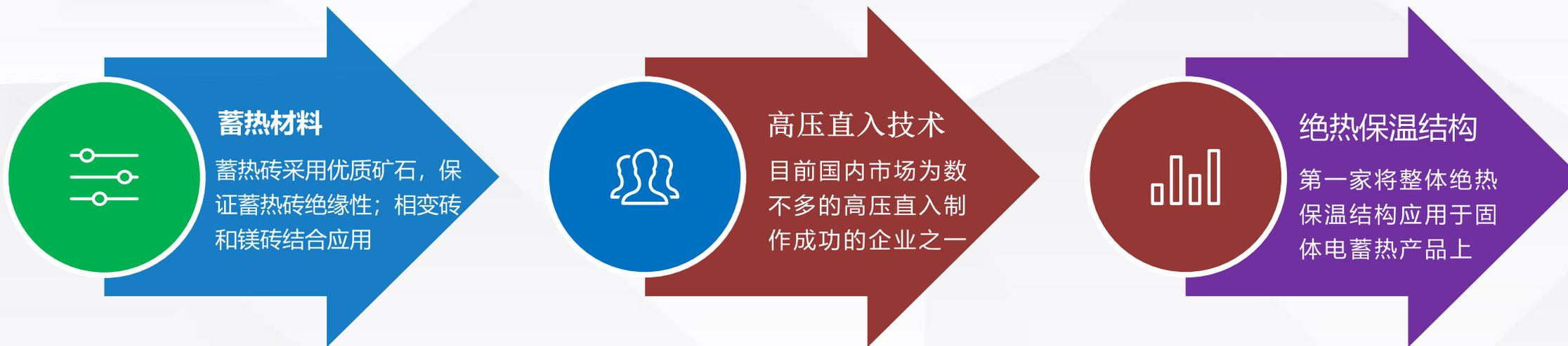
固体电蓄热调峰项目是利用峰、谷、平电价差, 在低谷电时段直接蓄热, 利用电加热将蓄热体加热到750°C储存起来, 并以热能形式储存在蓄热体器内供白天峰或平电时段使用, 满足供暖所需热量, 以达到完全降低峰、平电时段的用电量, 削峰填谷, 大大减少运行费用的目的。
